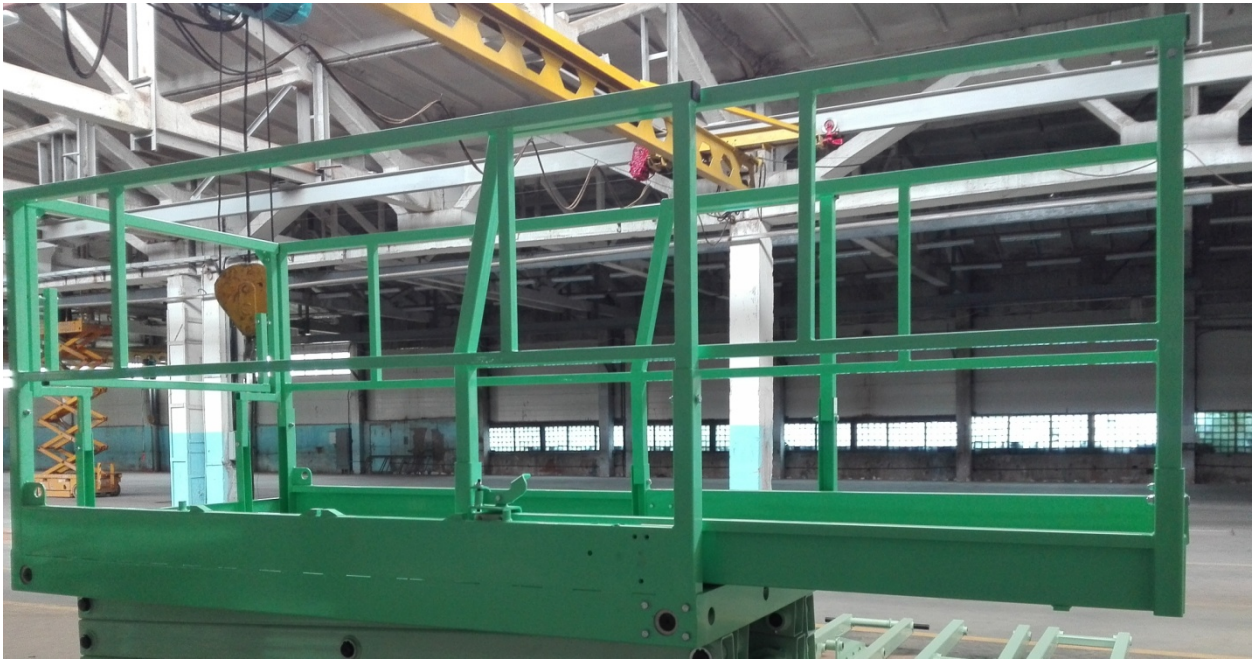
Рис 11 - Рабочая платформа с выдвинутой секцией.
