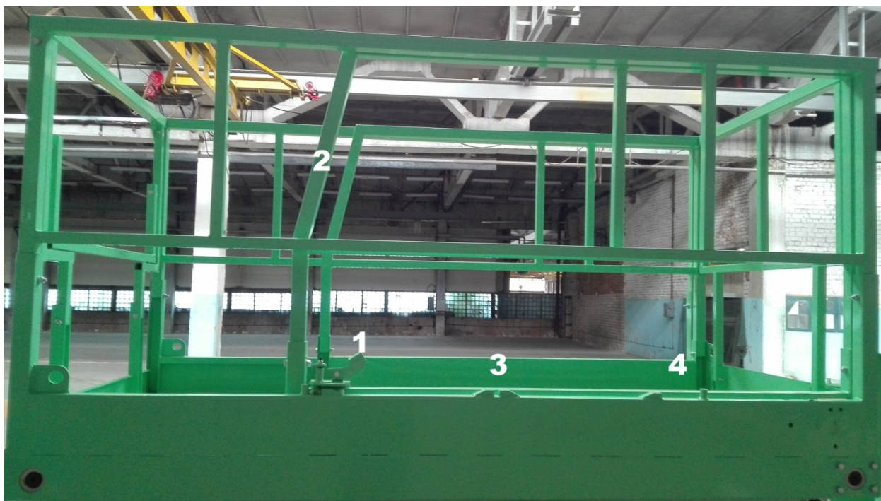
Рис 10 - Рабочая платформа со сложенной выдвигной секцией.
